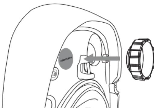
3. 加油時·可將油箱蓋吸附在砂膠片上避免油箱蓋滑落
